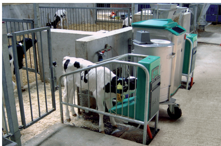
Abbildung 17: Beispiel für einen Tränkeautomat mit Tränkeabrufstation für Kälber (Quelle: Holm und Laue)
