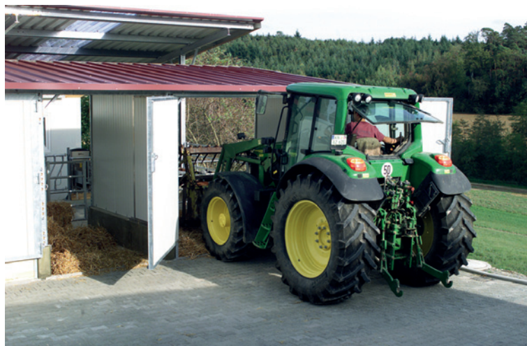
Abbildung 13: Frontlader-Entmistung der Gruppenhütte (Quelle: Förster-Technik)
